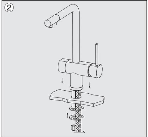
Colocar el grifo montado por encima del sanitario, y por debajo, colocar las fijaciones.
